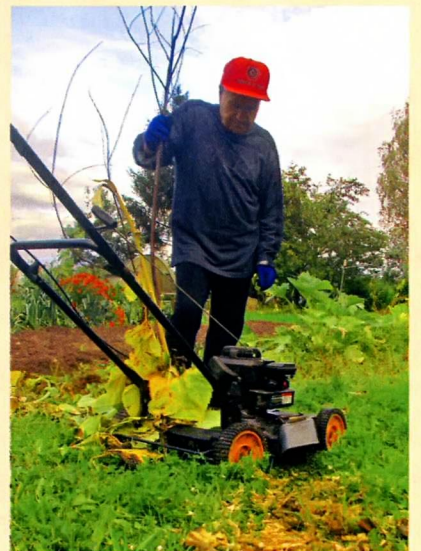
В трубу просовываю ветки и стебли растений, а газонокосилка превращает их в щепу.
