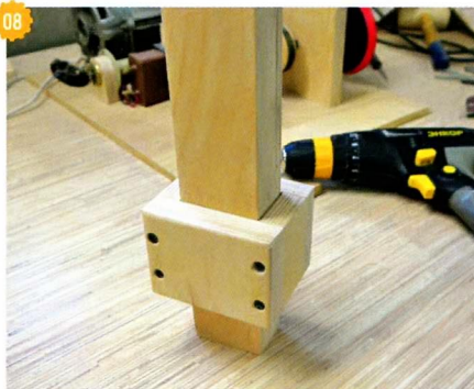
08 Подвижную коробку для крепления верхнего ролика установил на стойку.
