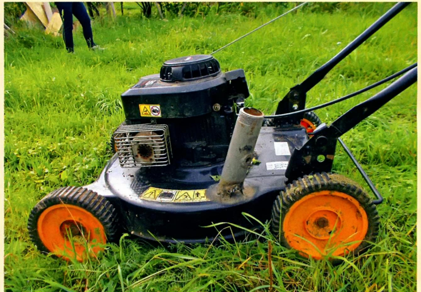
Мотокосилка с закреплённой в корпусе трубой становится ещё и измельчителем веток.
