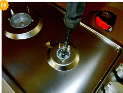
09 Замена форсунок газовых горелок.
