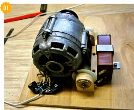
01 Двигатель установил на основании из многослойной фанеры.
