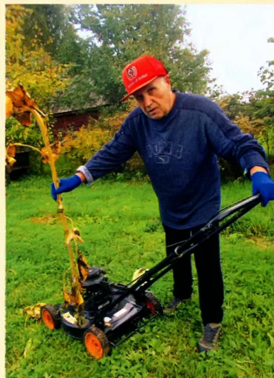
В трубу просовываю ветки и стебли растений, а газонокосилка превращает их в щепу.
